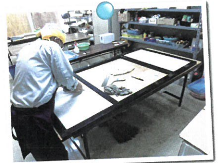
▲障子・襖張り作業
