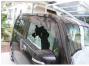
飛石による破損した 運転席側のガラス
