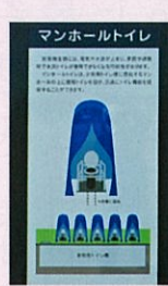
マンホールトイレ (64基) マンホールの上に便座と囲いを設置すると簡易トイレになります
