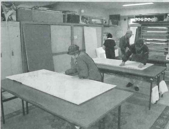
襖の張り替え作業
