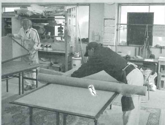
網戸の張り替え作業
