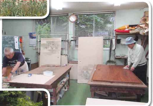
ふすま張り作業
