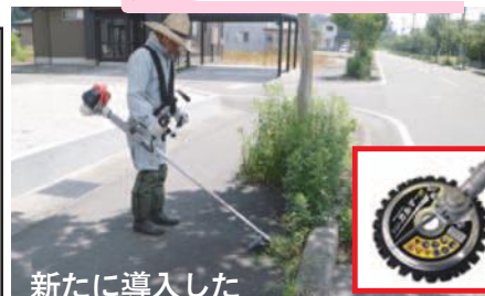
新たに導入した石跳ねが少ない草刈り機で作業中
