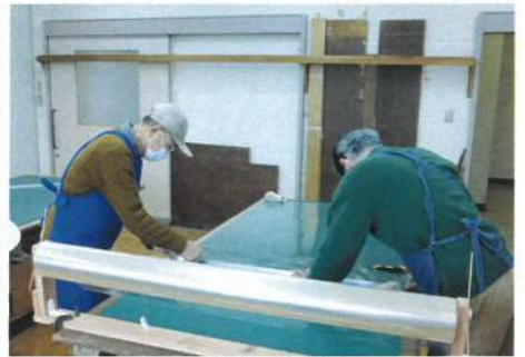
ガラスの飛散防止フィルム張り作業
