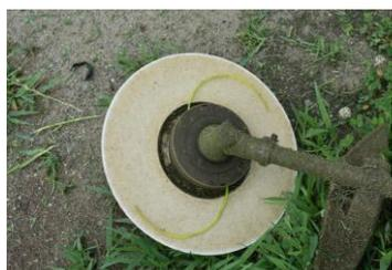
ナイロン紐での刈払い作業時には、紐と固定具との間に円盤状の板をセットして飛び石防止を行ったり(写真参照)、近くに車等がある場合の刈払い作業では、回転数を落とす等飛び石による事故を防いでいるとのことでした。
