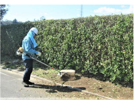
試作品のナイロンカッター用飛び石防止器具で作業中の木村会員
