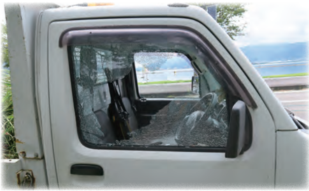
昨年の飛び石事故による車両の破損
