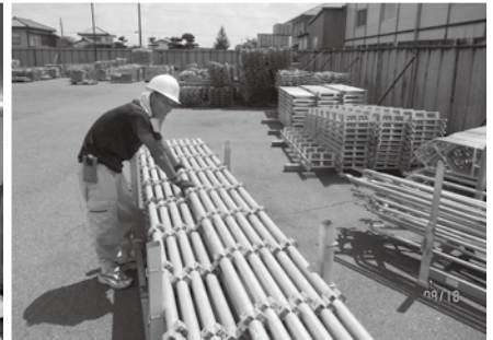
足場材の整備
