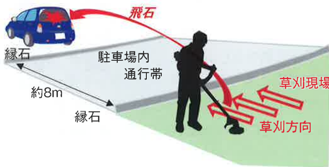
(1) 駐車場内草刈での事故例 草刈箇所と車の距離約 8m、問題は無いと思い作業したところ、飛石でリアガラスを破損。 ★気の緩みで発生した事故。常に気を引き締めて。
